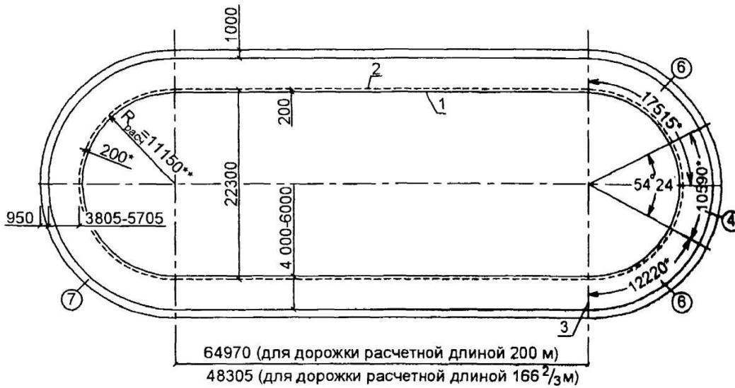
**Б. С СОПРЯЖЕНИЕМ ПРЯМЫХ ОТРЕЗКОВ И ПОВОРОТОВ ПРИ ПОМОЩИ ПЕРЕХОДНОЙ КРИВОЙ (КЛОТОИДЫ)**
