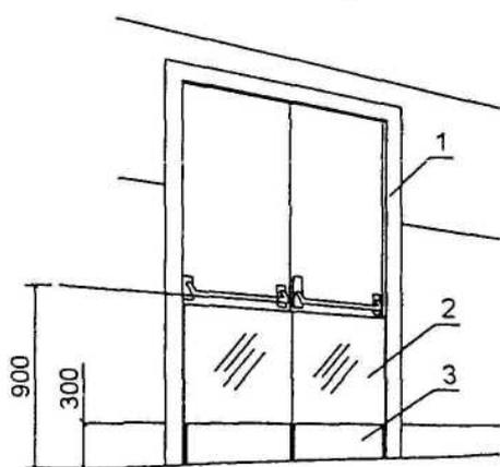
1 — наличник двери (устанавливается в одной плоскости со стеной зала)
