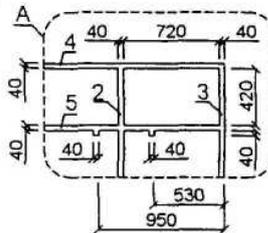
Все линии разметки — толщиной 40 мм. Линии входят в размеры площадки.
