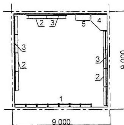
1 — гимнастическая стенка; 2 — станок хореографический; 3 — зеркало; 4 — место инструктора; 5 — стеллажи для переносного оборудования; 6 — коврики для занятий в партере; 7 — тренажер вращения; 8 — тренажер «Стенка»; 9 — тренажер «Ритм»; 10 — тренажер для бега; 11 — тренажер гимнастический; 12 — устройство для развития тазобедренного сустава; 13 — велотренажер; 14 — тренажер для гребли; 15 — тренажер для развития мышц спины; 16 — маты
