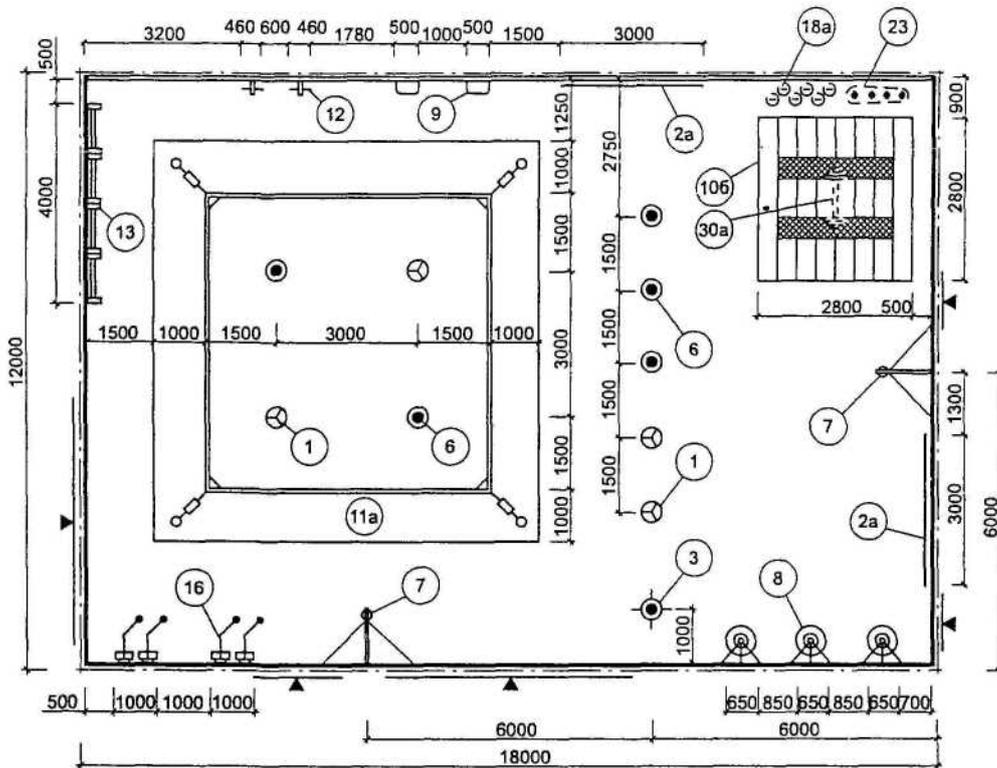
Примечание – На чертеже приведен вариант ринга (№ 11а), при котором стойки ринга устанавливаются в стаканы, забетонированные в пол.
