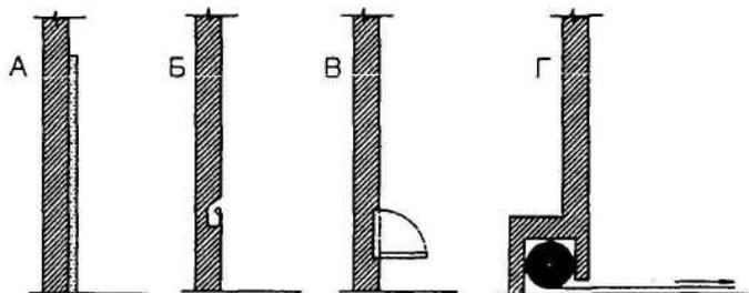
А — мягкая обивка стен (на высоту 3 м при батуте и 2 м для гимнастики и борьбы)
